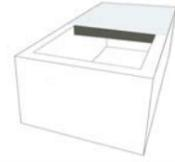
Konstruktionsbeton: NPK C 30/37 XC4, Dmax 32
