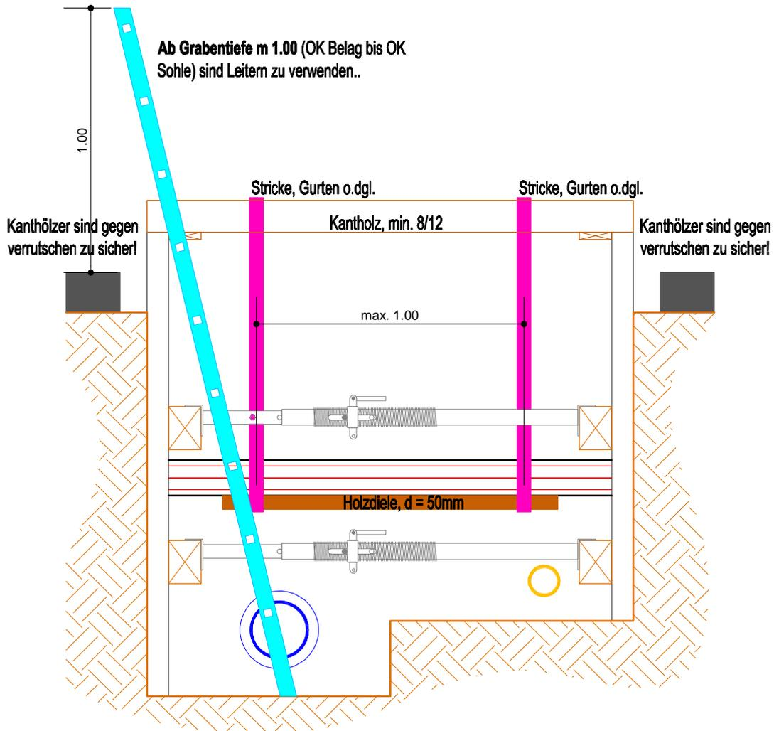
Längsschnitt, Leitung längs im Graben
